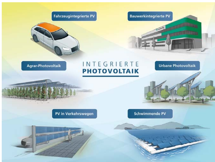
Abbildung 31: Anwendungen für die Integration von Photovoltaik
